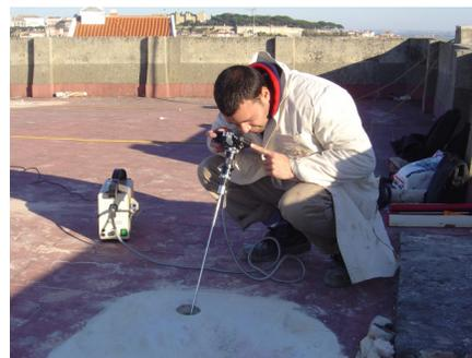
Fig. 3 – Observação do interior de um pavimento.
