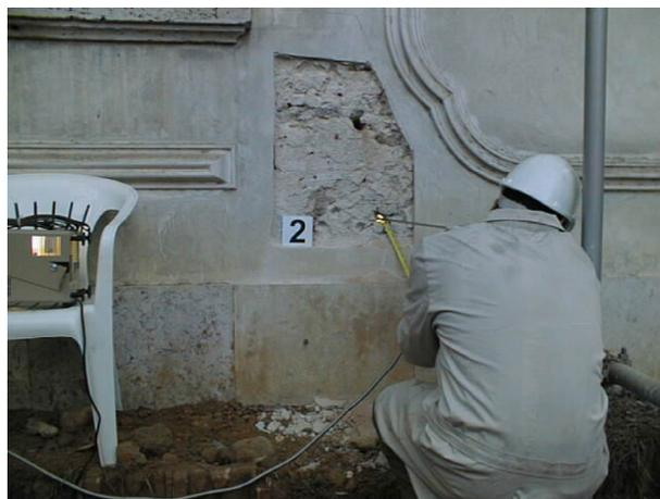
Fig. 5 - Observação boroscópica de uma parede.
